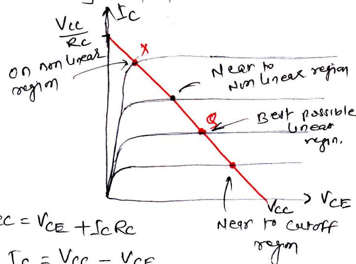
$$V_{CC} = V_{CE} + I_C R_C$$
